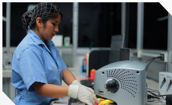
Espectrofotómetro UV/2000F para medición de Factor de Protección UV
